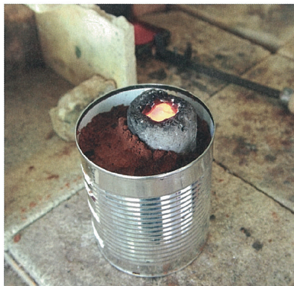
Sturzguss in die gebrannte Schamotte-Stützform.
