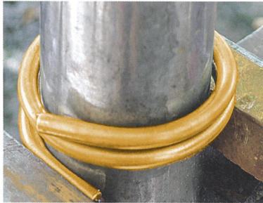
Das Scharnier wird um einen Armreifriegel gewickelt.
