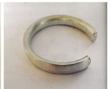
Der Armreif wird durch mehrfaches Erhitzen in Form gebracht.
