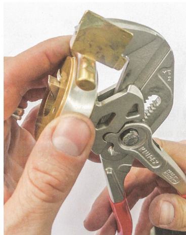
Das Scharnier wird um einen Armreifriegel gewickelt.
