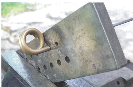
Das Rohr rollt sich hinter dem Zieheisen ein.
